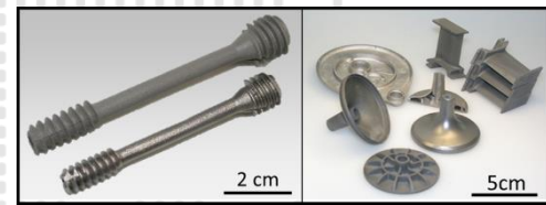
Funktionsmuster (links: Knochenschraube; rechts: Diverse MIM-Teile) | Bild: HZG/WBM
